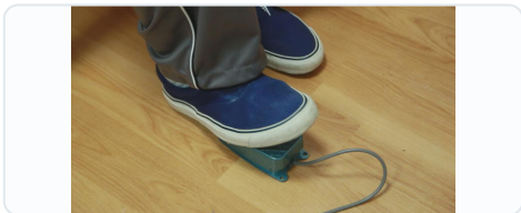
スイッチを踏む操作を発射と連動
